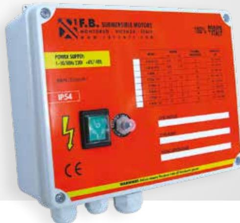
Řada ovládacích panelů IC-DUAL je určena k ovládní jednofázových ponorných elektročerpadel a je vybavena dvojitým externím rozběhovým kondenzátorem, který zajišťuje vysoké rozběhové momenty. Při rozběhu napěťové relé odpojí elektrolytický kondenzátor, jakmile svorky druhého kondenzátoru dosáhnou určitého napětí.
