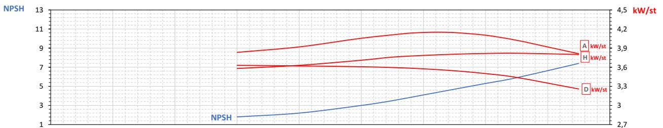
Maximální účinnost / Maximum efficiency / Rendement maximal / Rendimiento máximo **76,60%**
