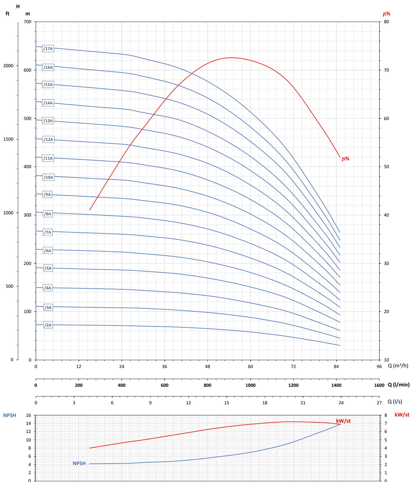
Maximální účinnost / Maximum efficiency / Rendement maximal / Rendimiento máximo **72,2%**
