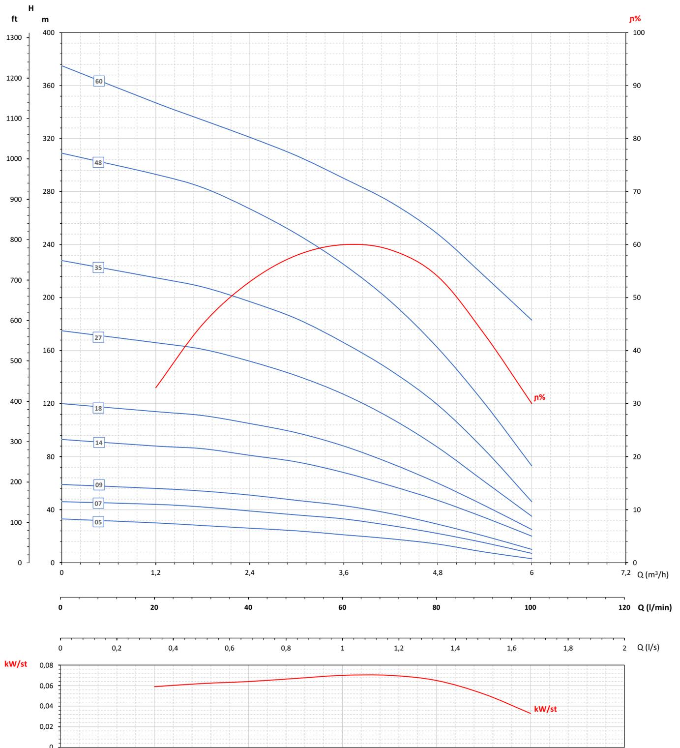
Maximální účinnost / Maximum efficiency / Rendement maximal / Rendimiento máximo 60,1%
