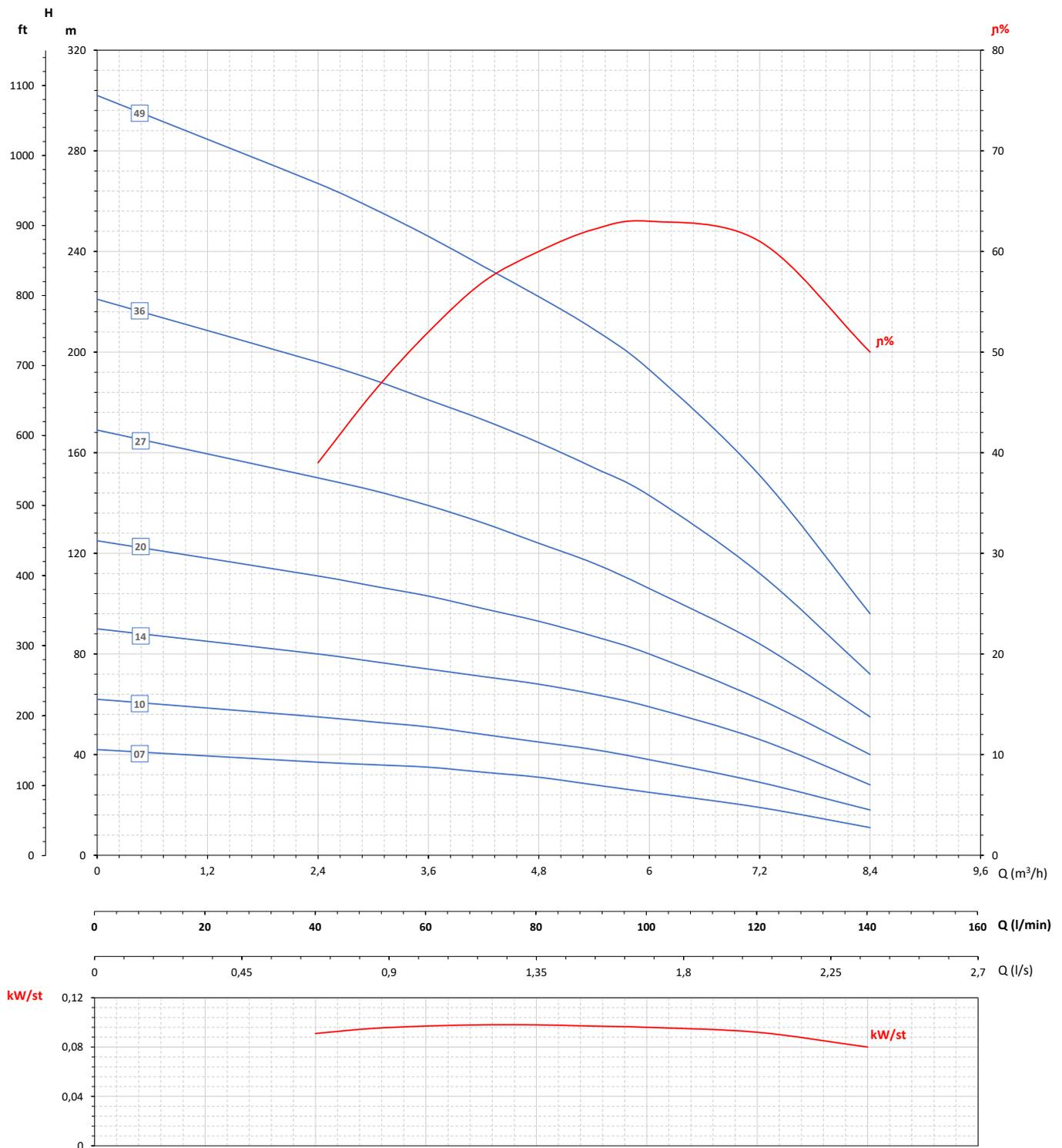
Maximální účinnost / Maximum efficiency / Rendement maximal / Rendimiento máximo 63%
