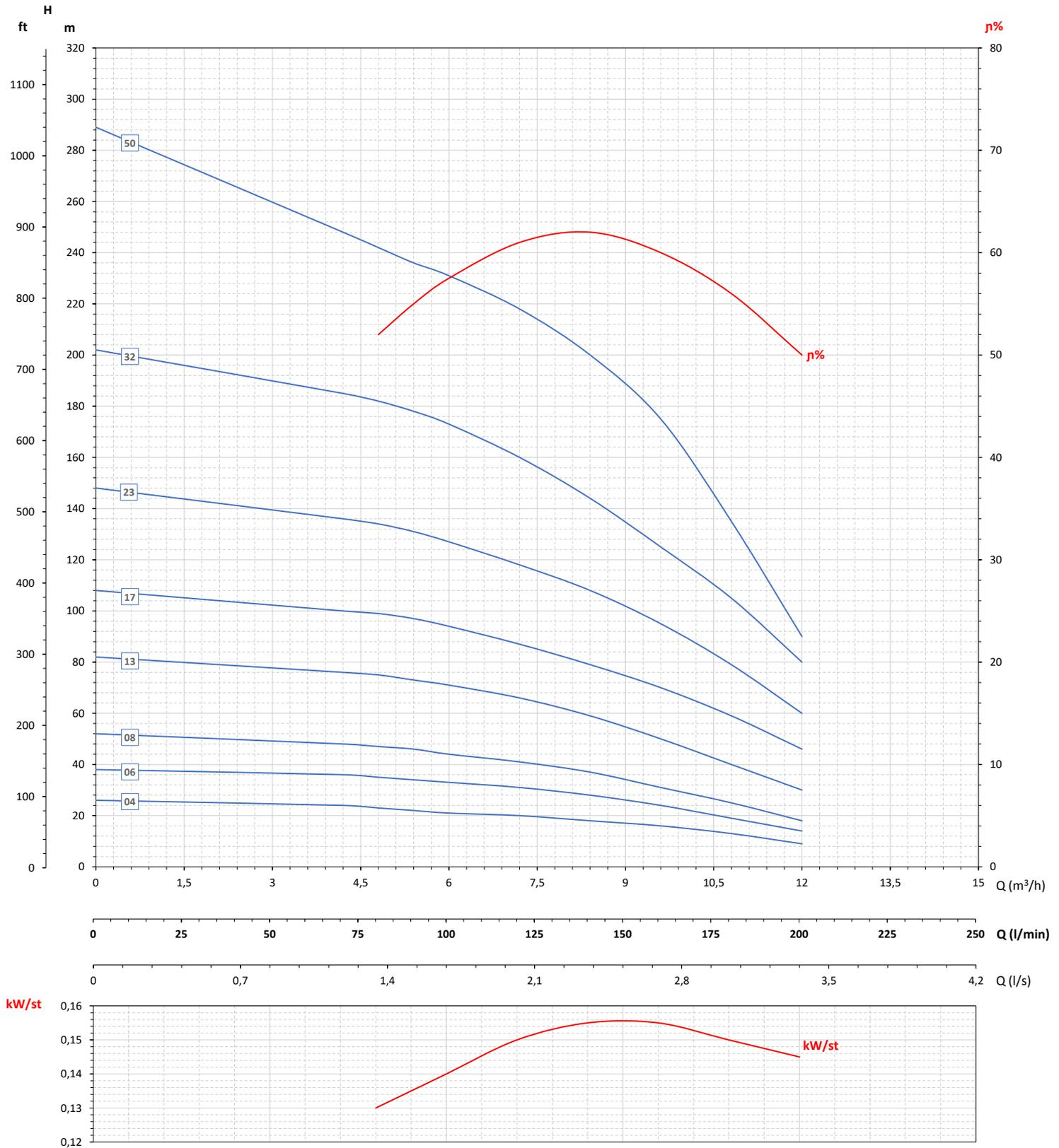
Maximální účinnost / Maximum efficiency / Rendement maximal / Rendimiento máximo 62%
