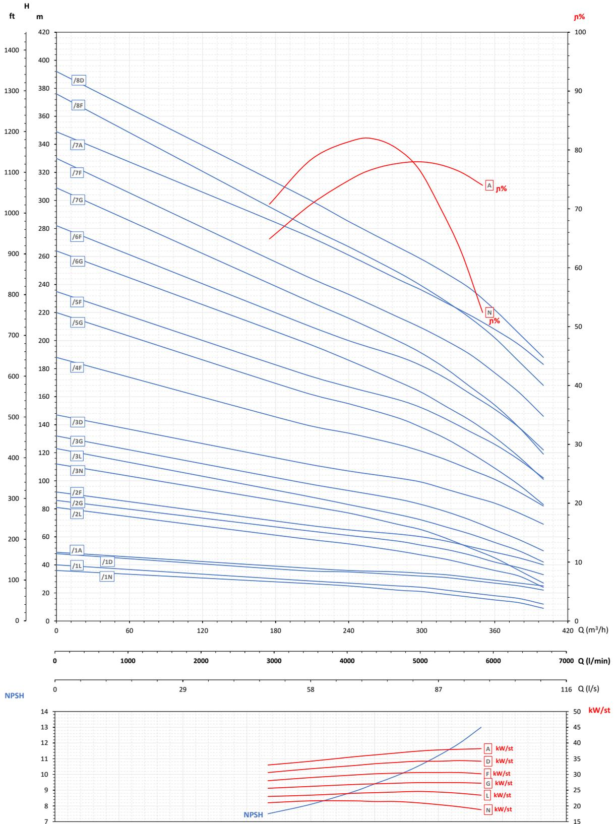
Maximální účinnost / Maximum efficiency / Rendement maximal / Rendimiento máximo 81,8%
