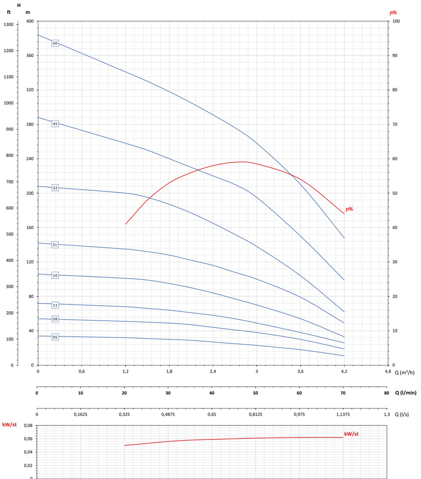
Maximální účinnost / Maximum efficiency / Rendement maximal / Rendimiento máximo 59,4%
