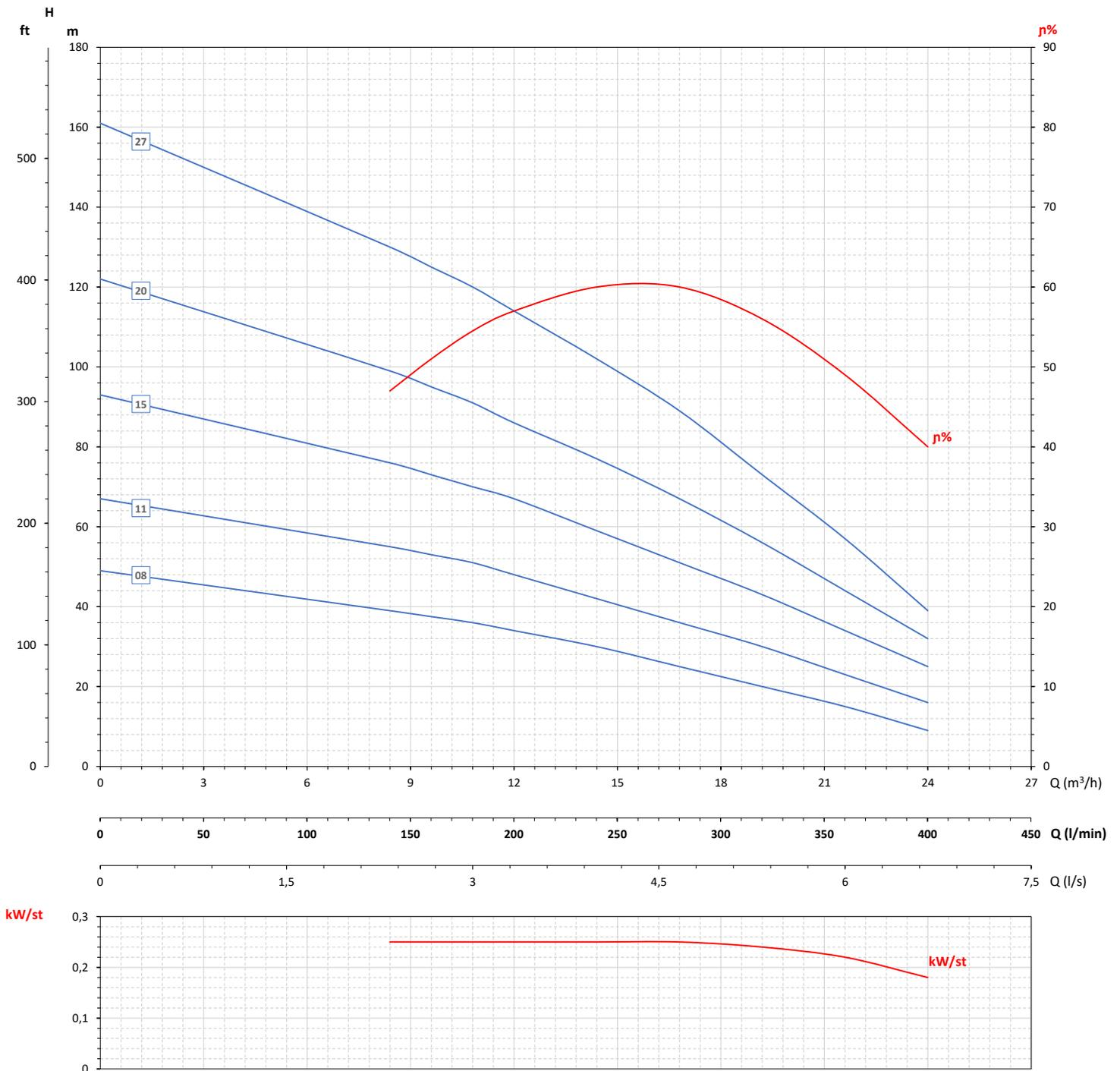
Maximální účinnost / Maximum efficiency / Rendement maximal / Rendimiento máximo **60,3%**
