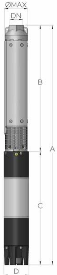
**\* Toto čerpadlo se nedoporučuje pro horizontální montáž.**
