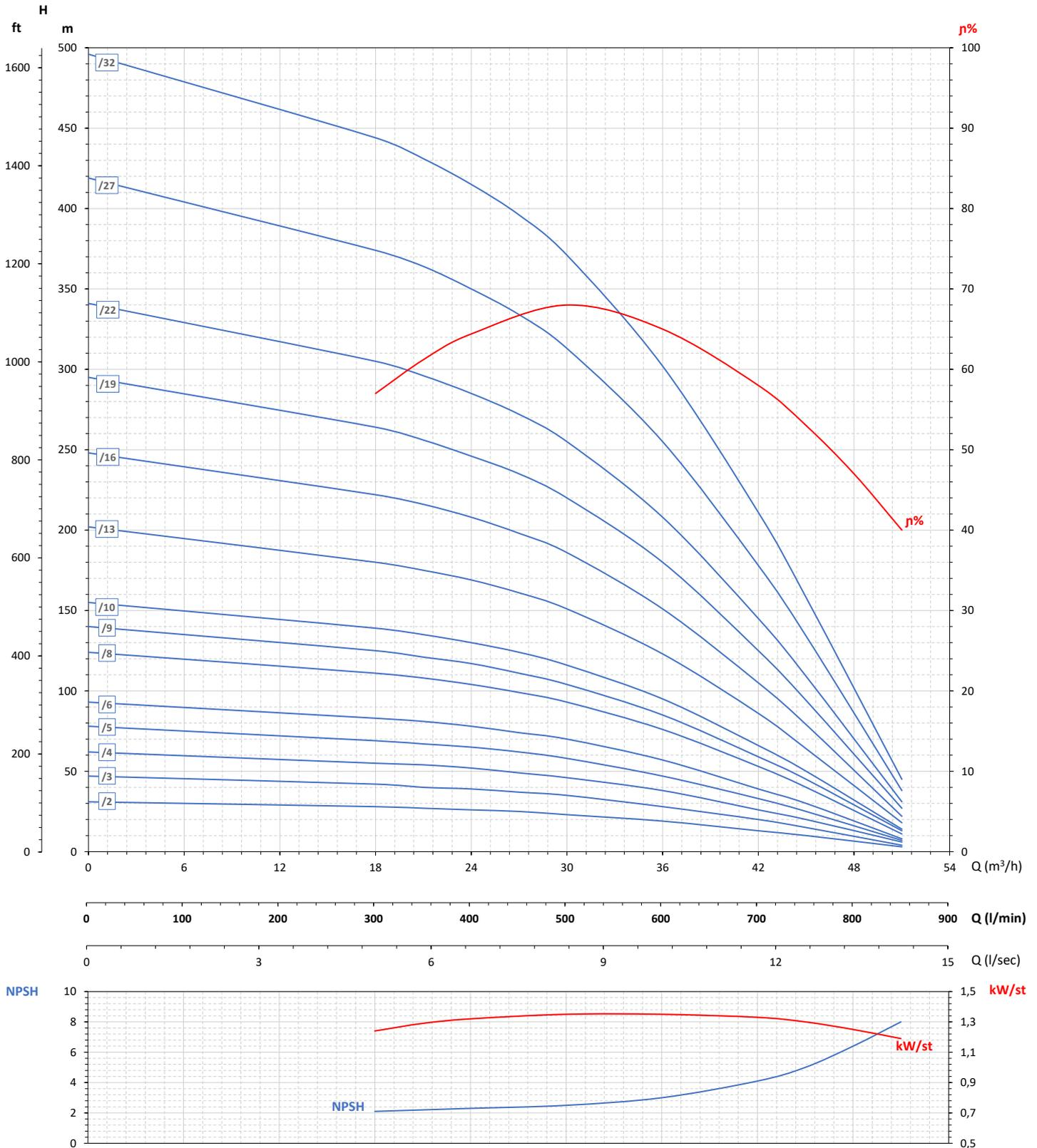
Maximální účinnost / Maximum efficiency / Rendement maximal / Rendimiento máximo 68%
