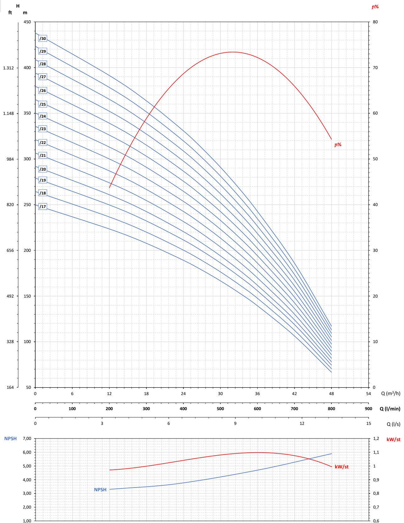
Maximální účinnost / Maximum efficiency / Rendement maximal / Rendimiento máximo **73,2%**
