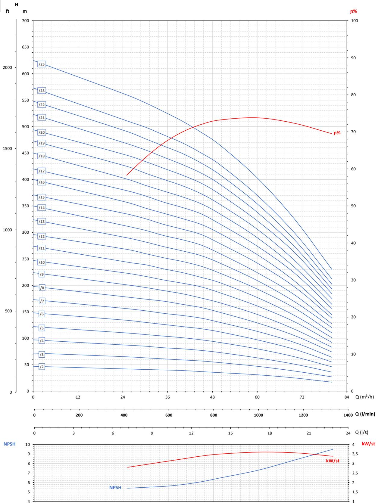
Maximální účinnost / Maximum efficiency / Rendement maximal / Rendimiento máximo **73,8%**
