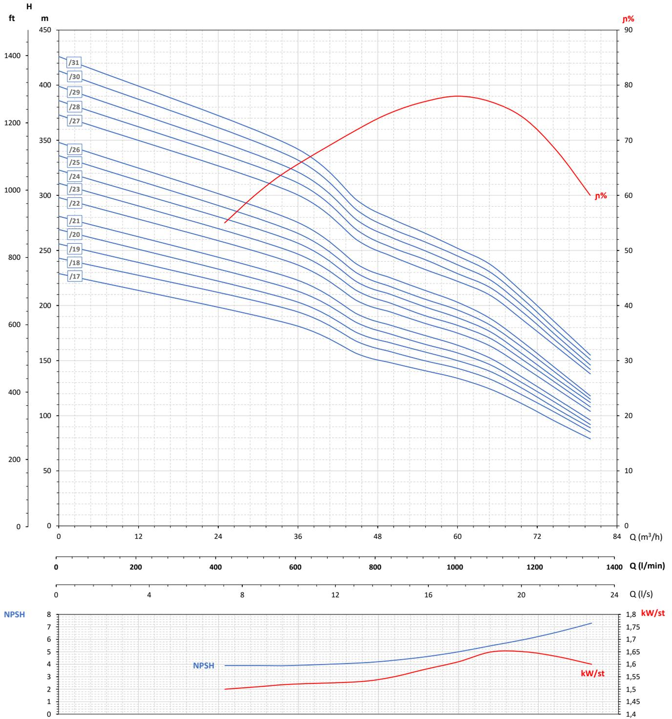
Maximální účinnost / Maximum efficiency / Rendement maximal / Rendimiento máximo **78%**
