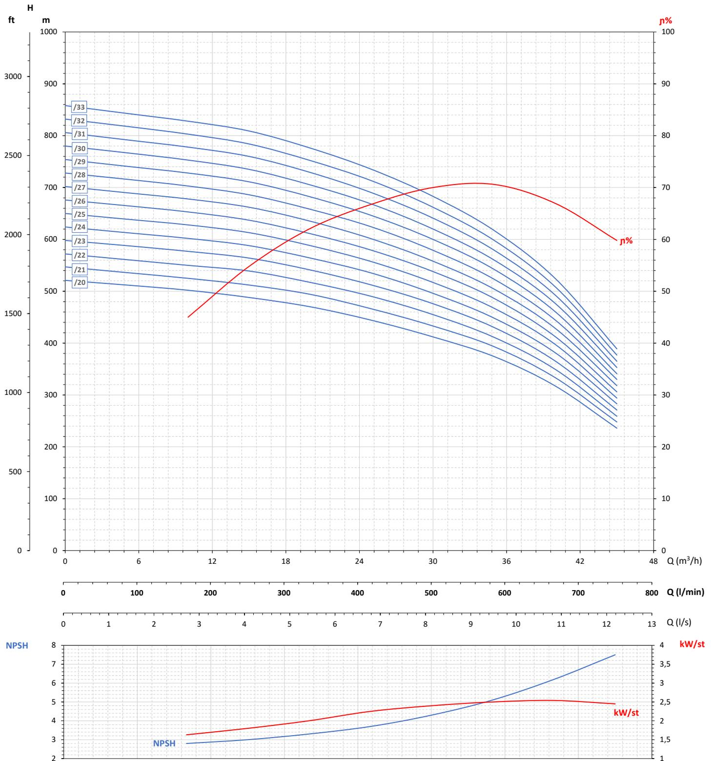
Maximální účinnost / Maximum efficiency / Rendement maximal / Rendimiento máximo **70,6%**
