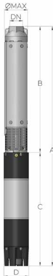
**\* Toto čerpadlo se nedoporučuje pro horizontální montáž.**
