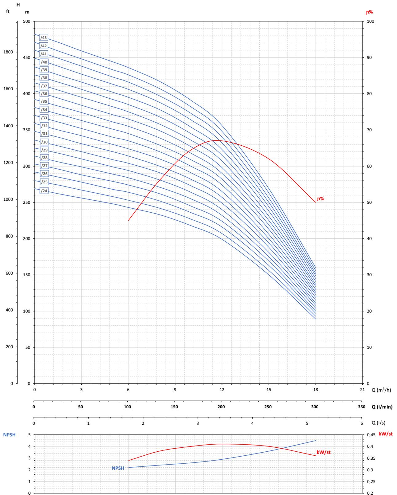
Maximální účinnost / Maximum efficiency / Rendement maximal / Rendimiento máximo 67%
