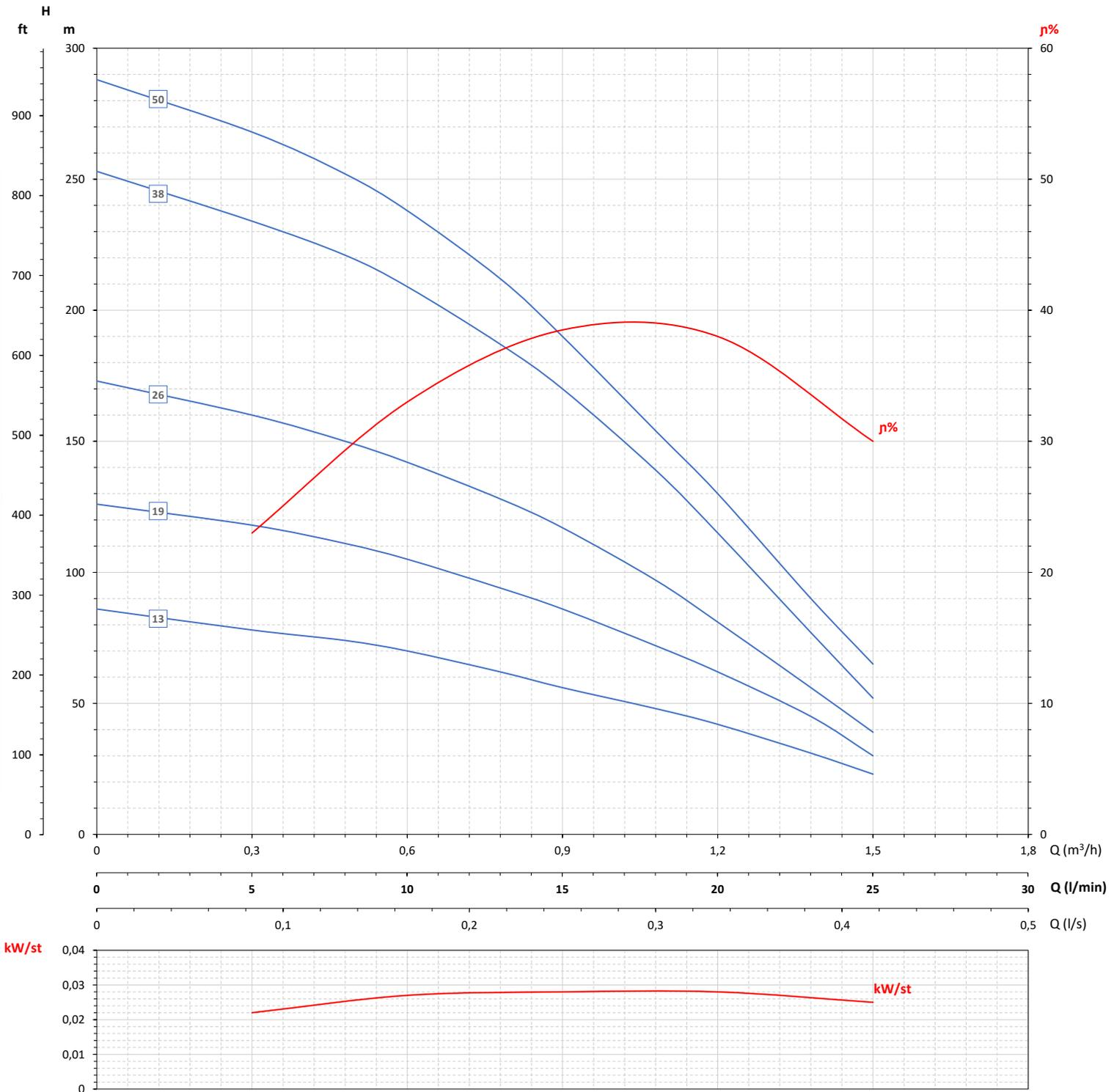
Maximální účinnost / Maximum efficiency / Rendement maximal / Rendimiento máximo **39,5%**
