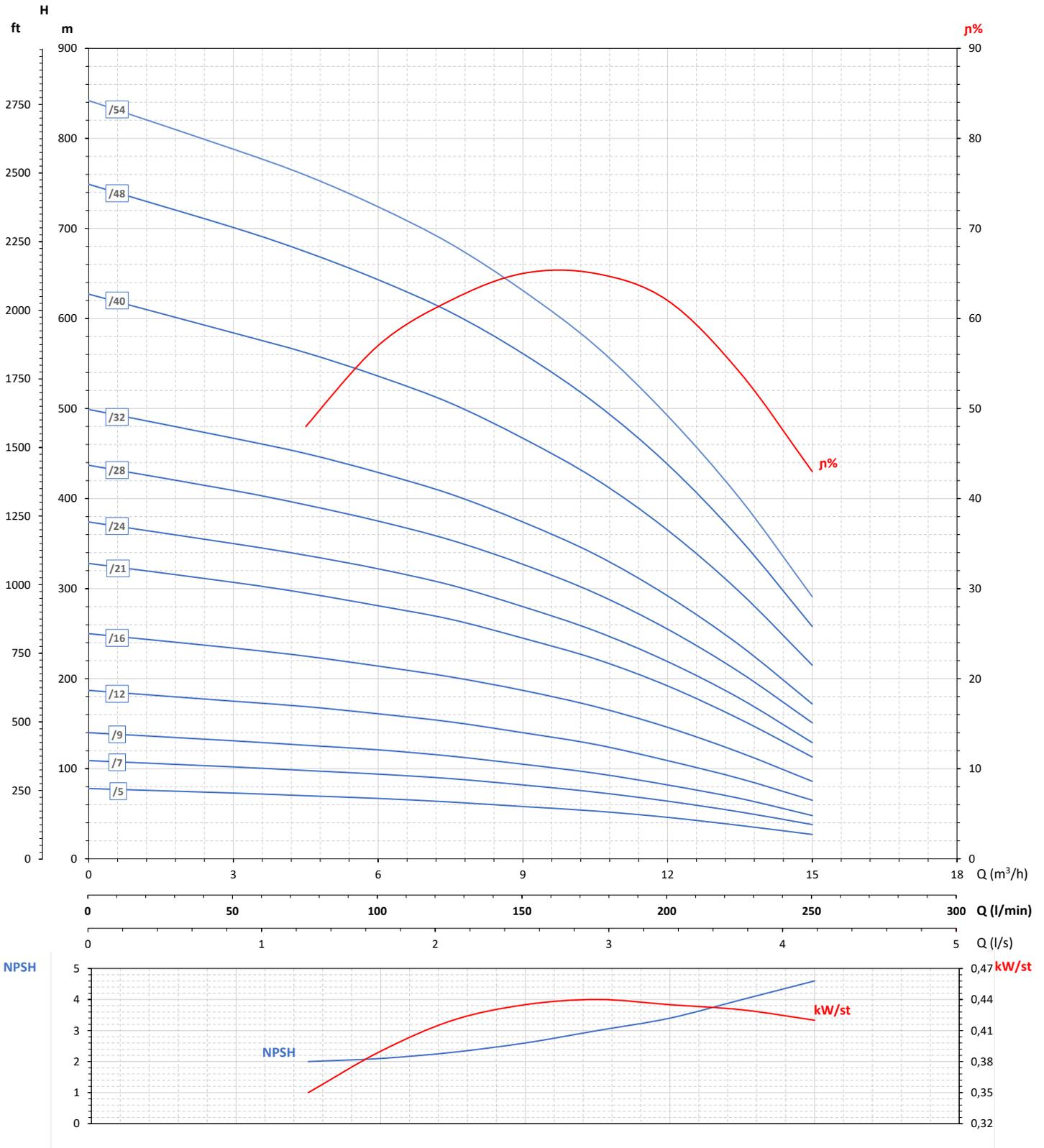
Maximální účinnost / Maximum efficiency / Rendement maximal / Rendimiento máximo 65%
