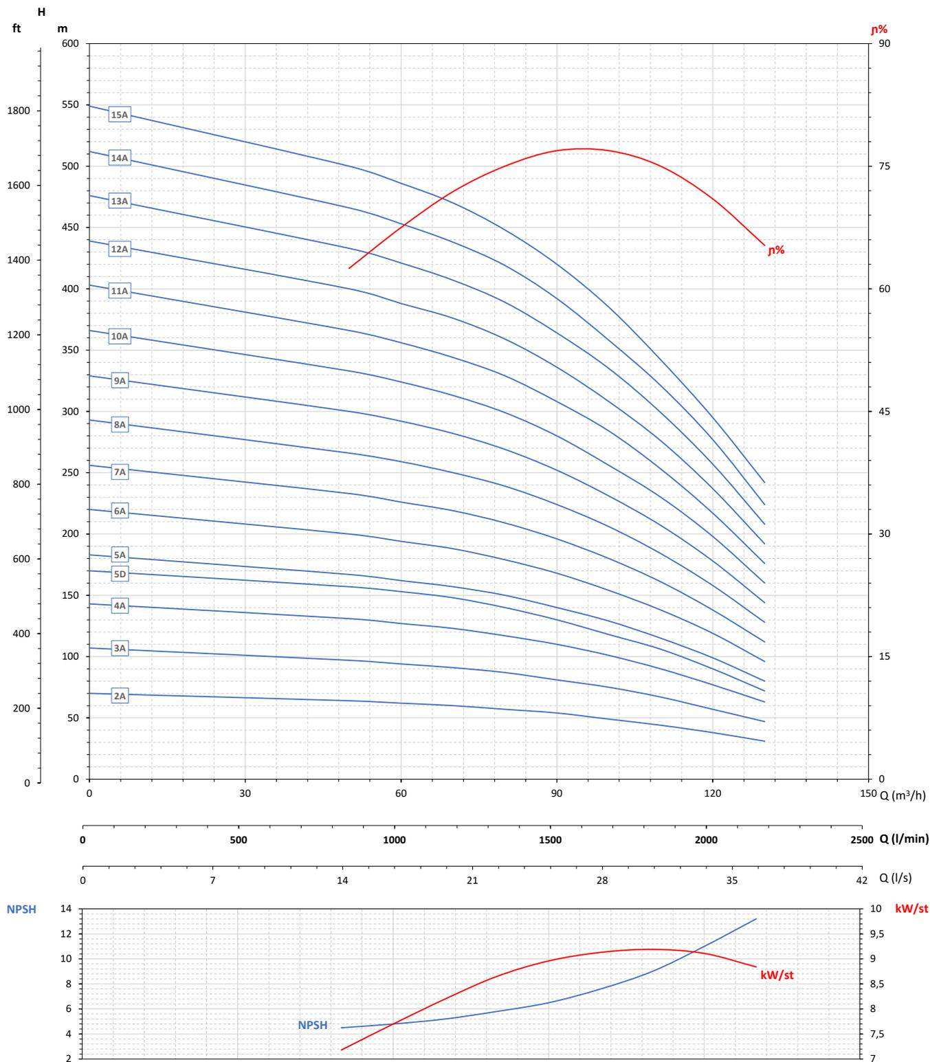
Maximální účinnost / Maximum efficiency / Rendement maximal / Rendimiento máximo **76,9%**
