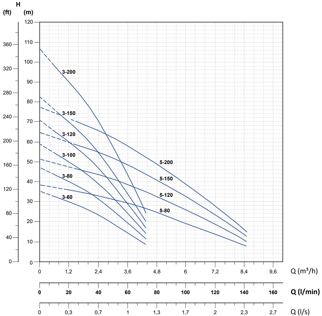
Tolerance podle EN ISO 9906 an.A Gr.2
