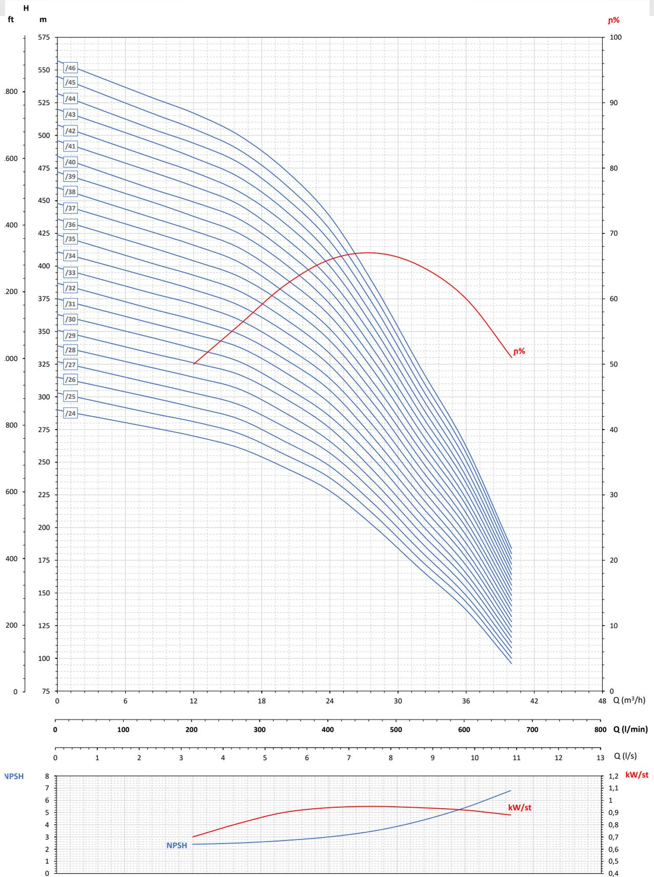
Maximální účinnost / Maximum efficiency / Rendement maximal / Rendimiento máximo **67%**
