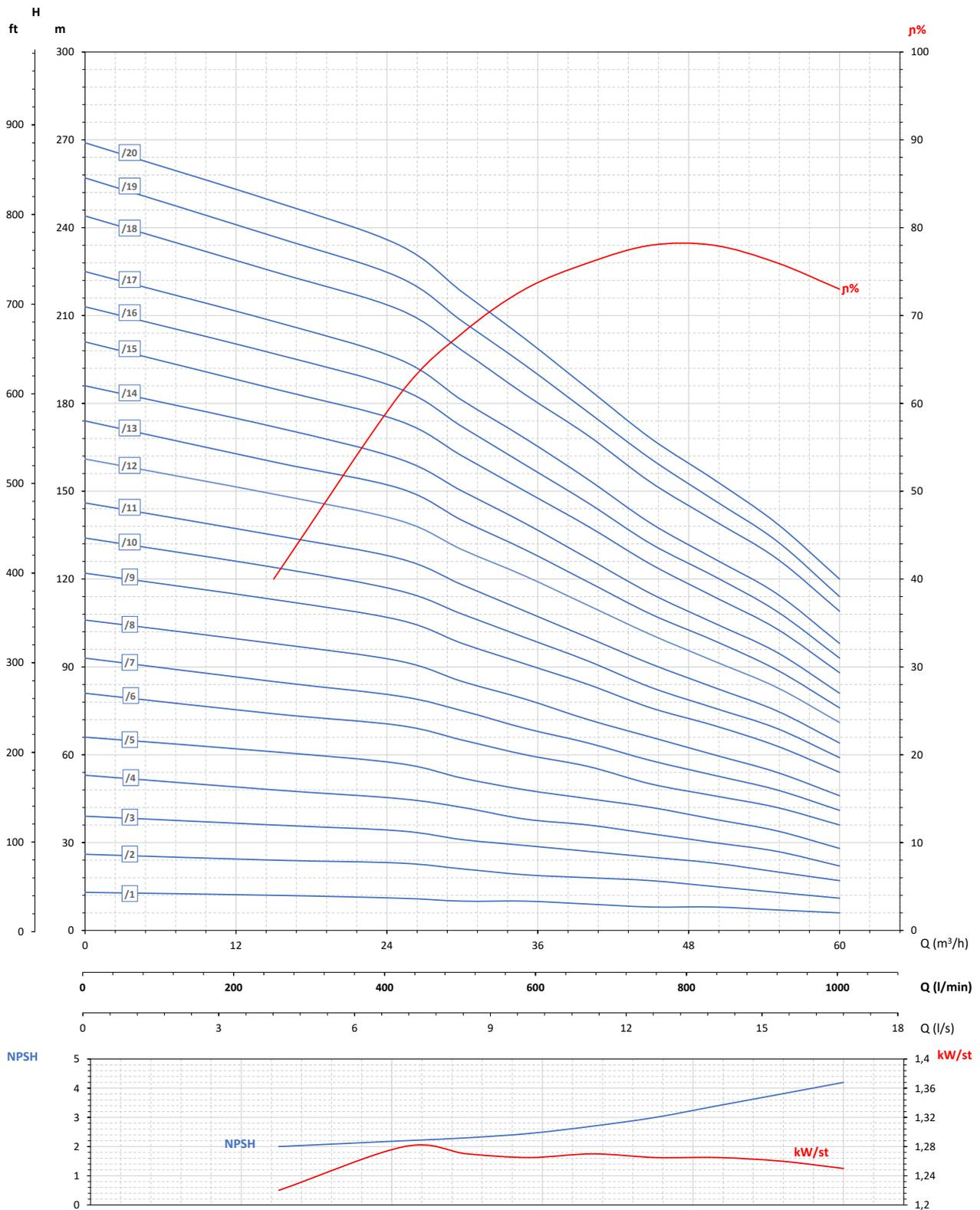
Maximální účinnost / Maximum efficiency / Rendement maximal / Rendimiento máximo 78%
