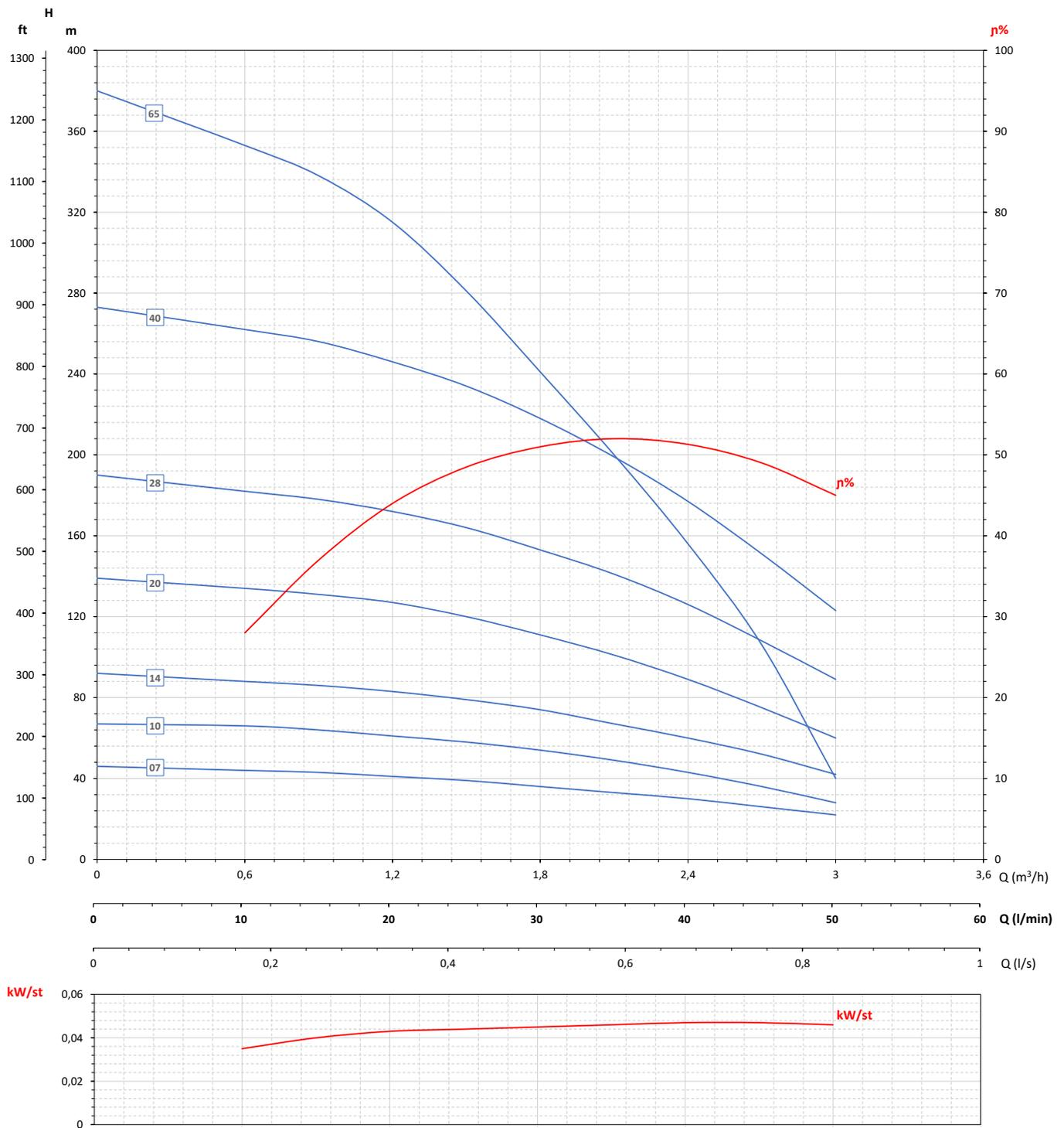
Maximální účinnost / Maximum efficiency / Rendement maximal / Rendimiento máximo 52%
