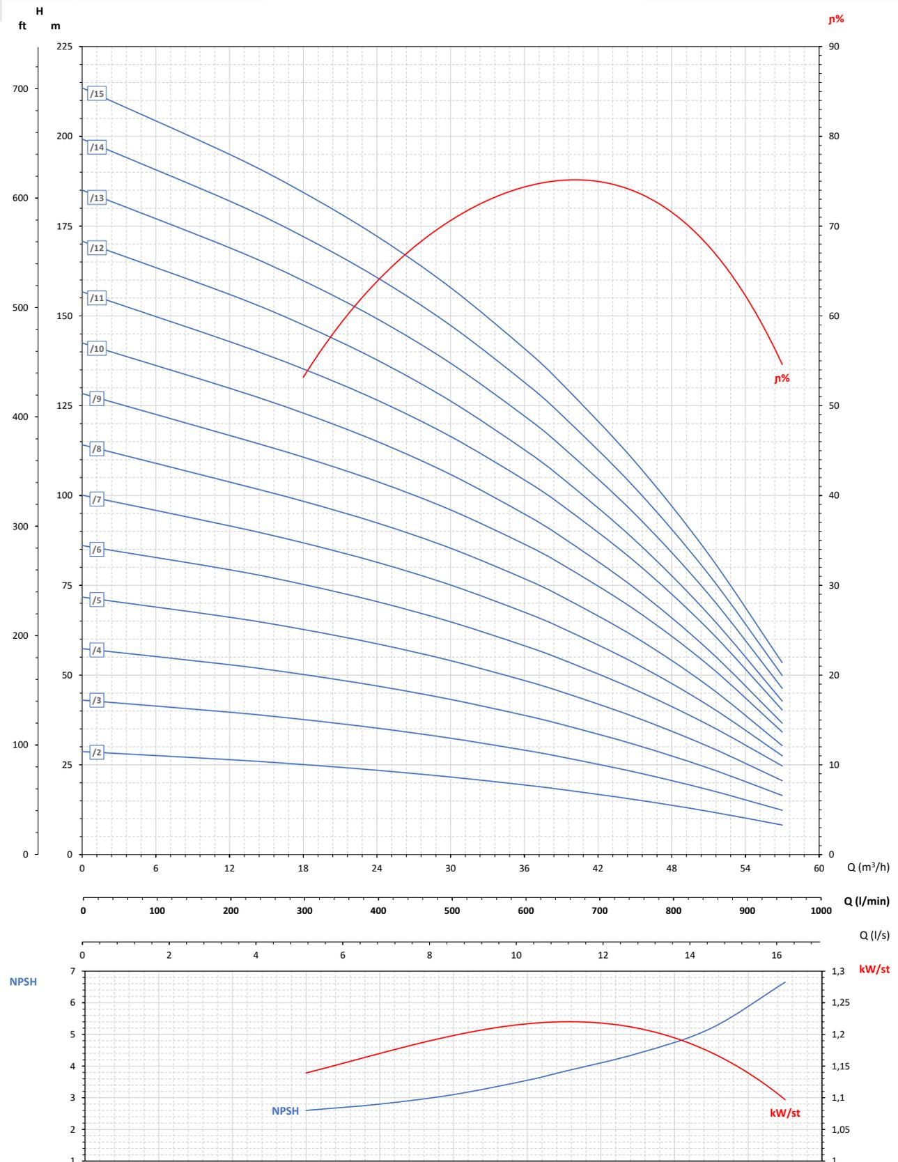
Maximální účinnost / Maximum efficiency / Rendement maximal / Rendimiento máximo **75,1%**
