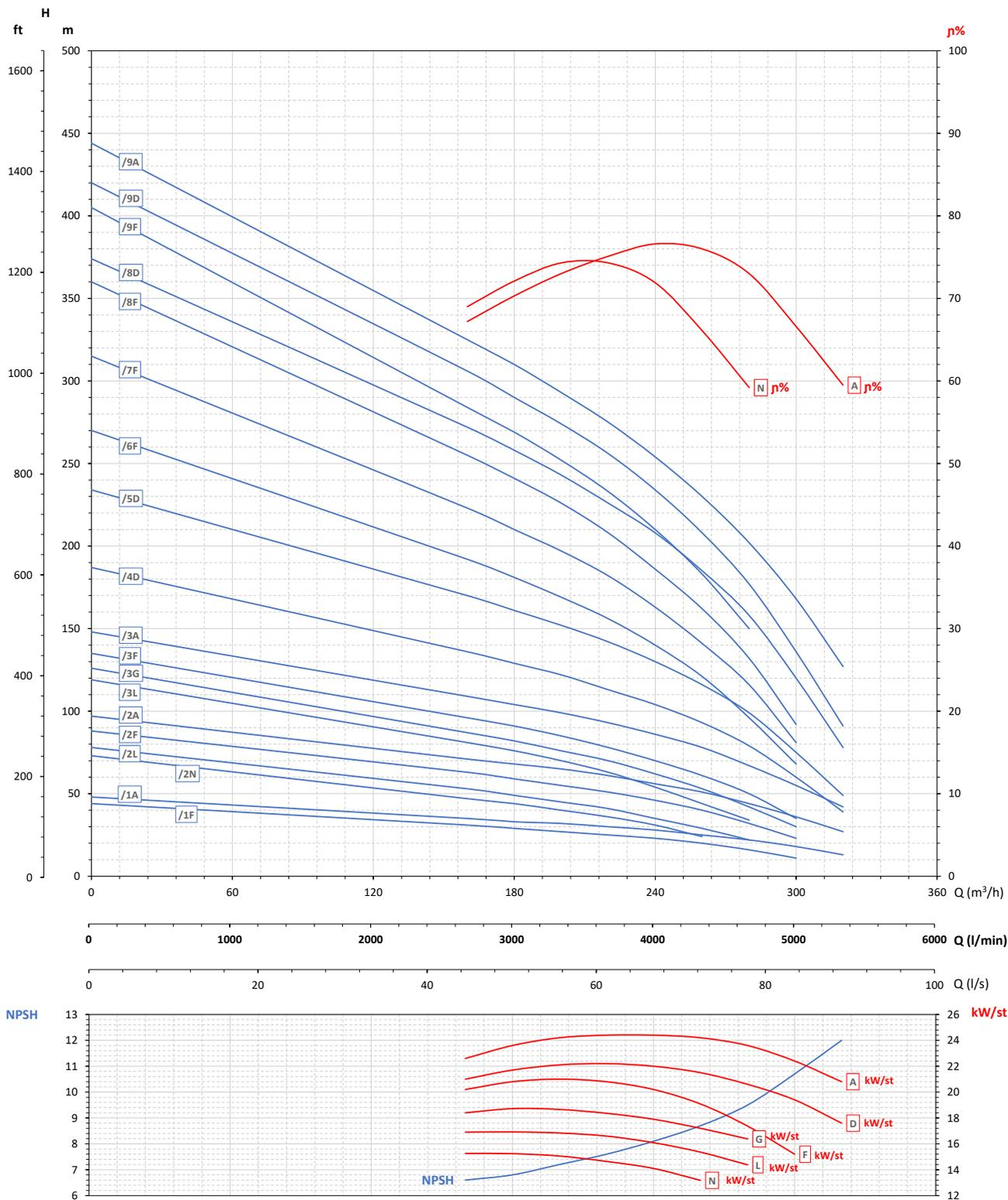
Maximální účinnost / Maximum efficiency / Rendement maximal / Rendimiento máximo **76,6%**
