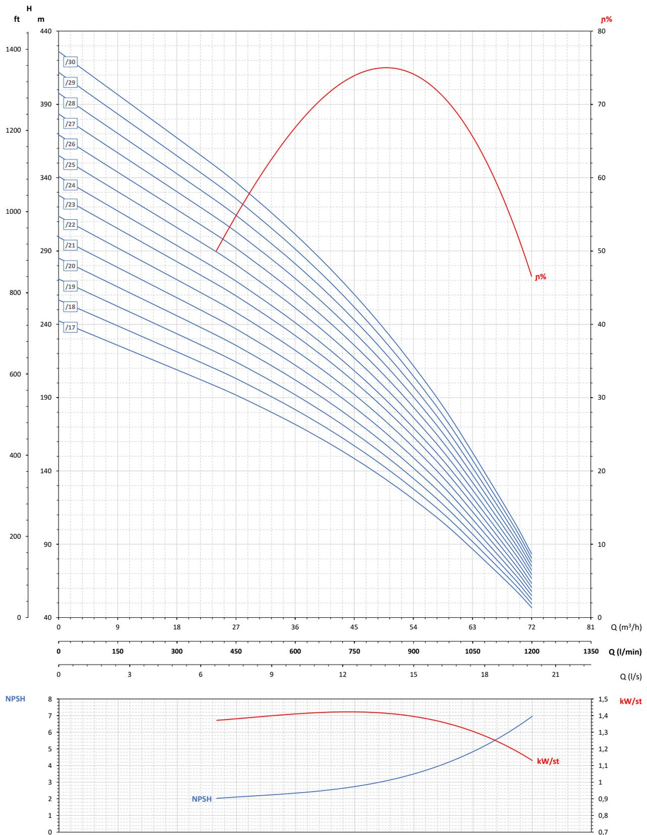
Maximální účinnost / Maximum efficiency / Rendement maximal / Rendimiento máximo **75%**
