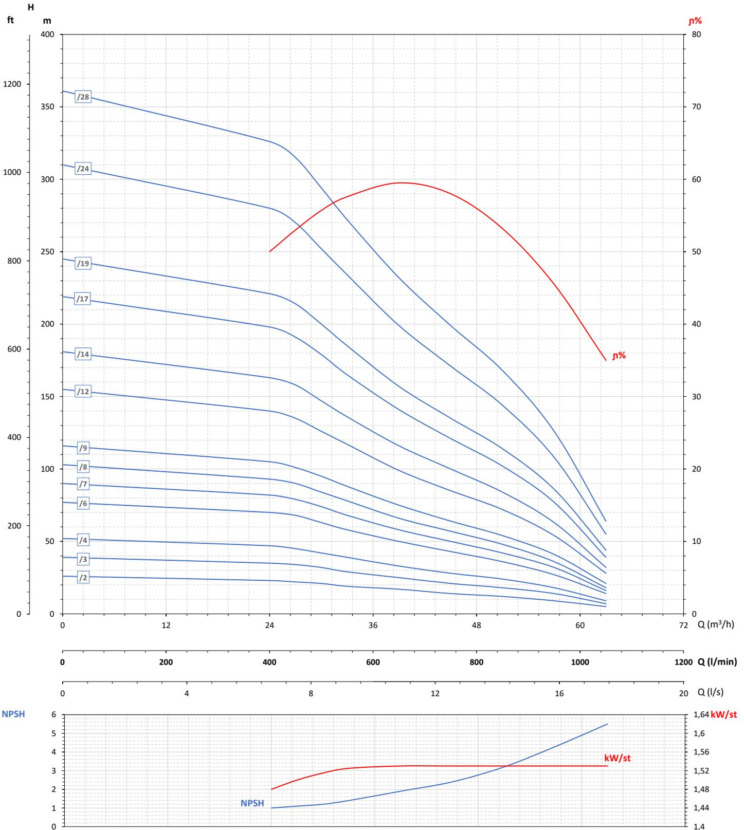
Maximální účinnost / Maximum efficiency / Rendement maximal / Rendimiento máximo **59,5%**
