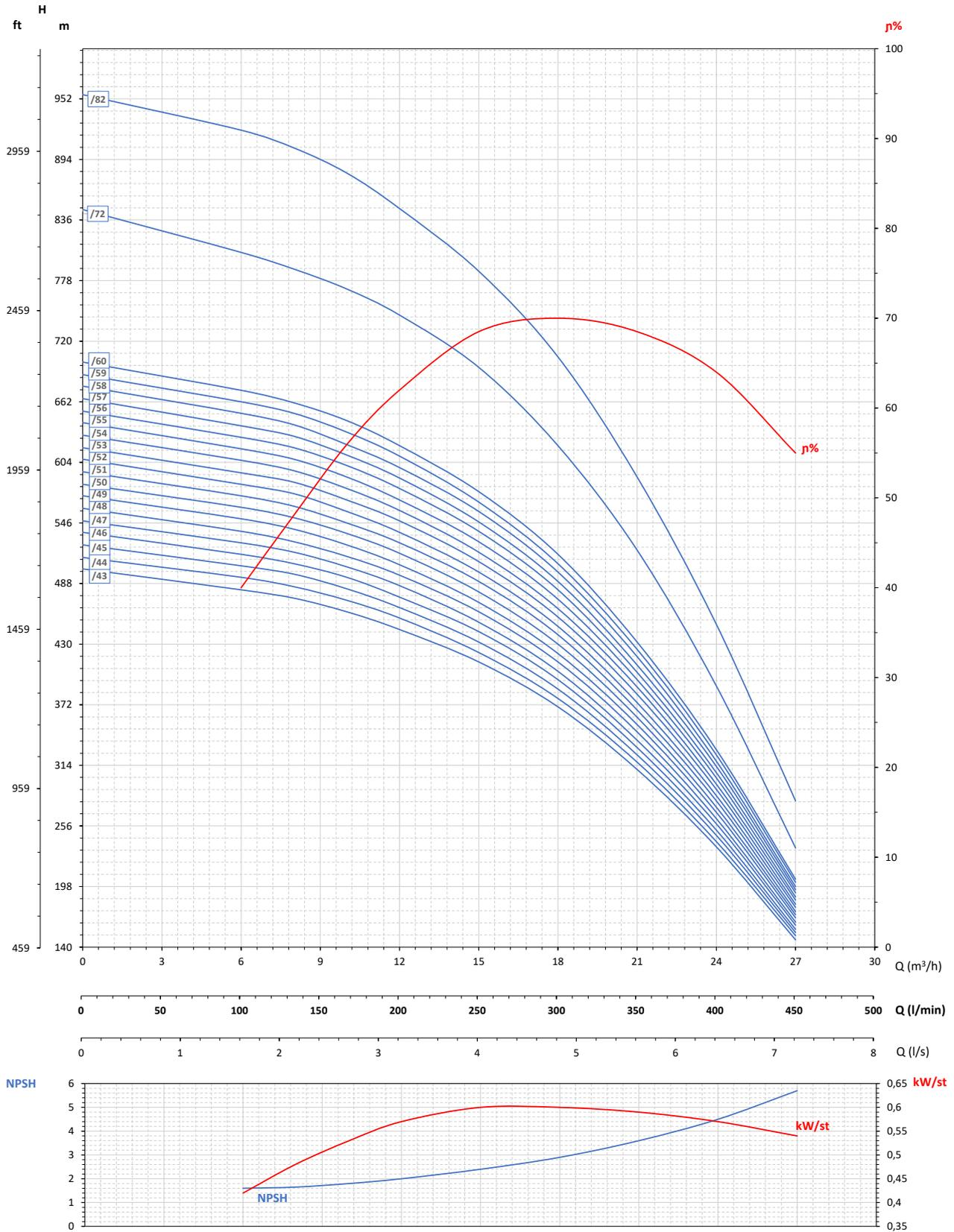
Maximální účinnost / Maximum efficiency / Rendement maximal / Rendimiento máximo **70%**
