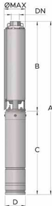
■ Těleso čerpadla a oběžná kola z nerezové oceli AISI 304
