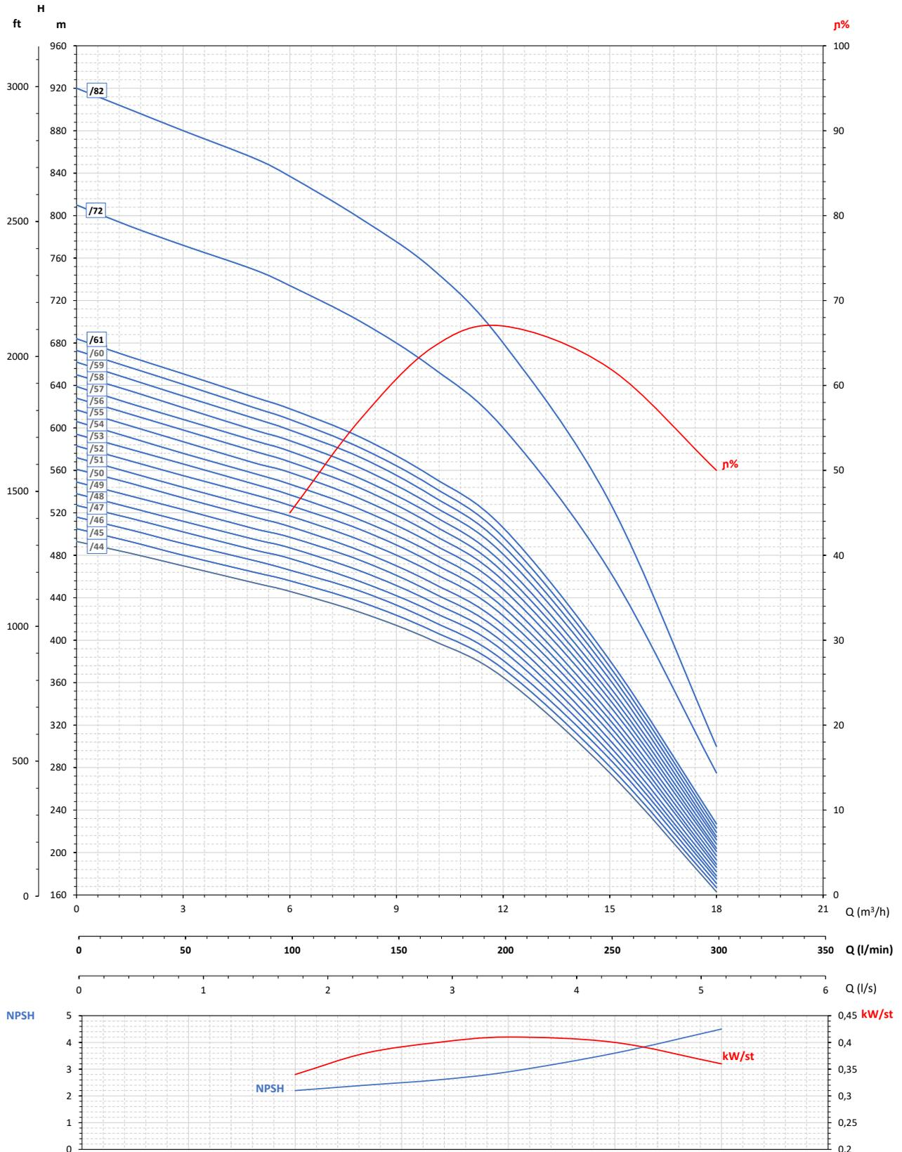
Maximální účinnost / Maximum efficiency / Rendement maximal / Rendimiento máximo **67%**
