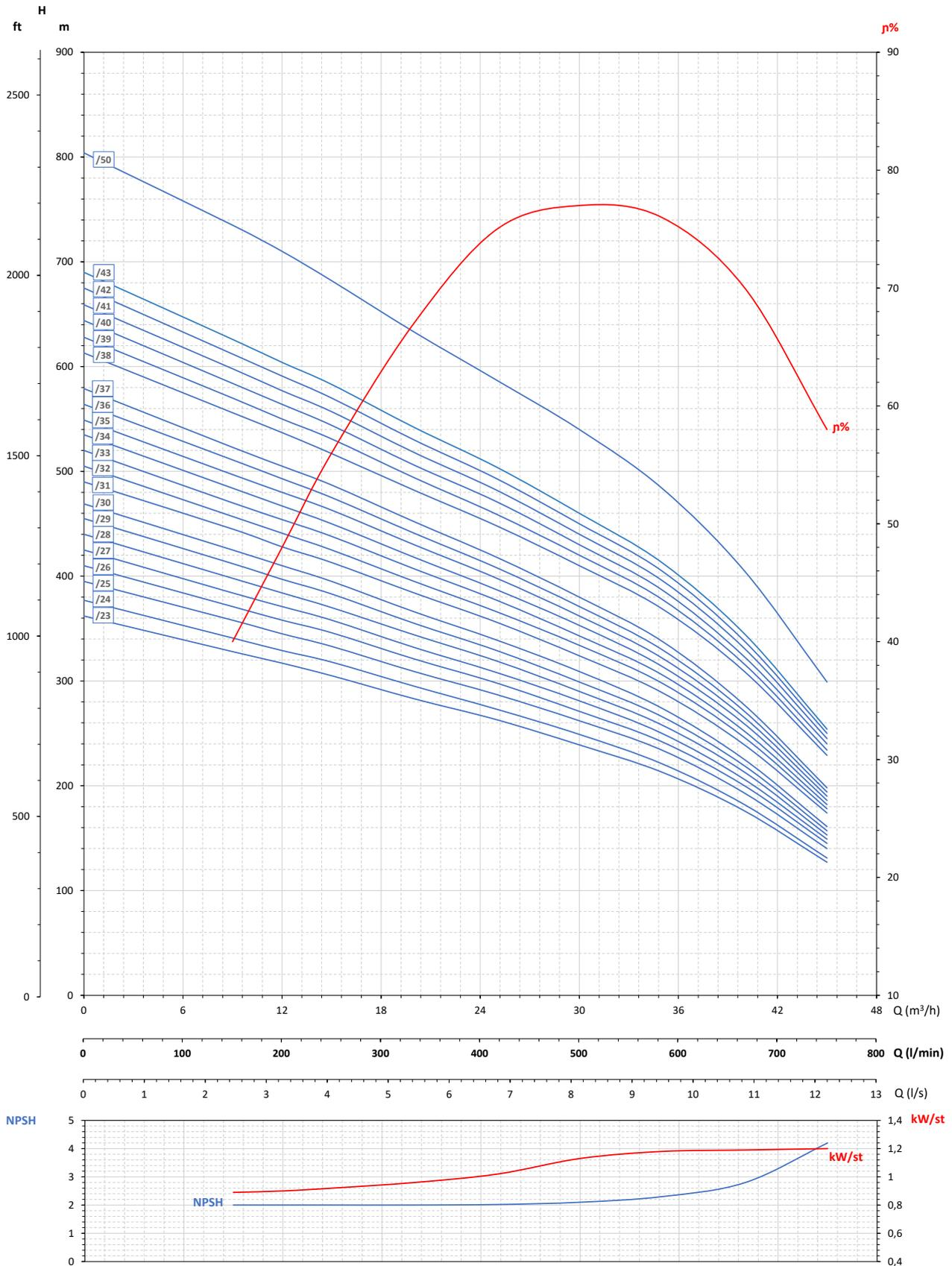
Maximální účinnost / Maximum efficiency / Rendement maximal / Rendimiento máximo **77%**
