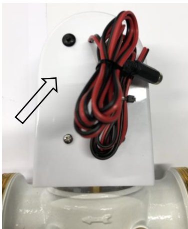
Obr.7 Odstraňte nýt na zadní straně krytu elektronické hlavy.
