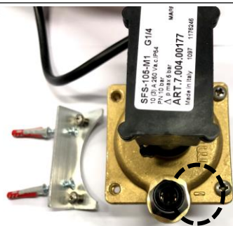
Obr.4-5 Přišroubujte kovový držák (D) k tlakovému diferenciálu (F) na symetricky opačné straně než držák se znaménkem „-“ (zakroužkovaný).
