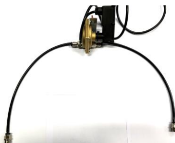
Obr.4-5 Přišroubujte kovový držák (D) k tlakovému diferenciálu (F) na symetricky opačné straně než držák se znaménkem „-“ (zakroužkovaný).
