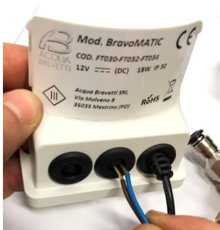
Obr.13 Zasuňte vodiče elektrického připojení tlakového diferenciálu (F) do středové kabelové průchodky zadního krytu elektronické části.
